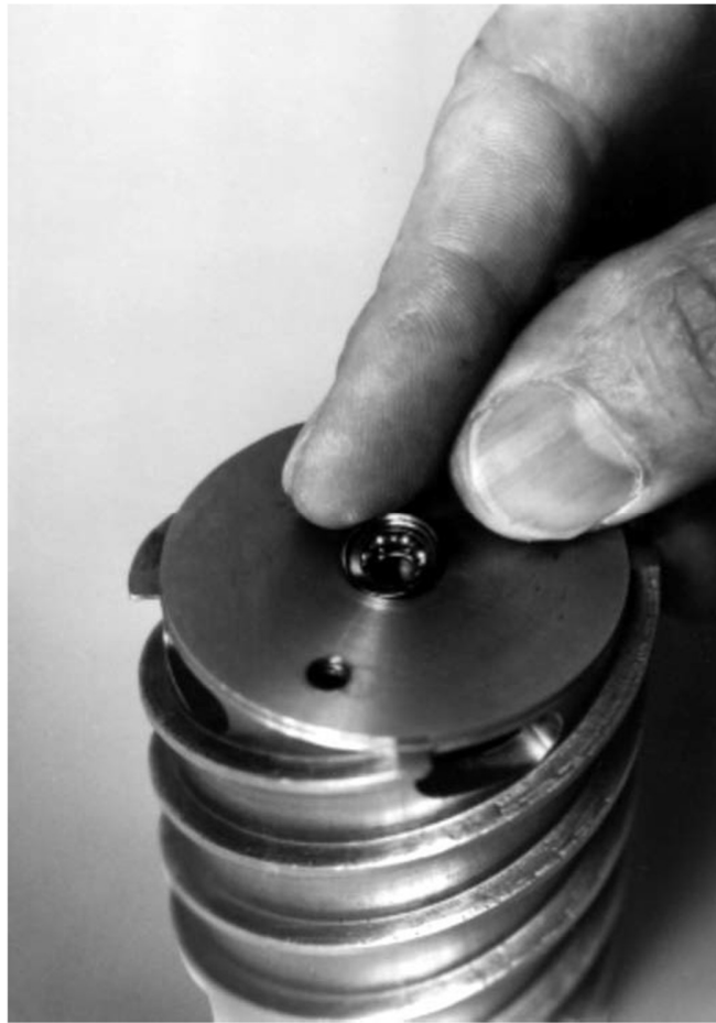
Figura 5-50 Colocando la pista externa del rulemán para presión
