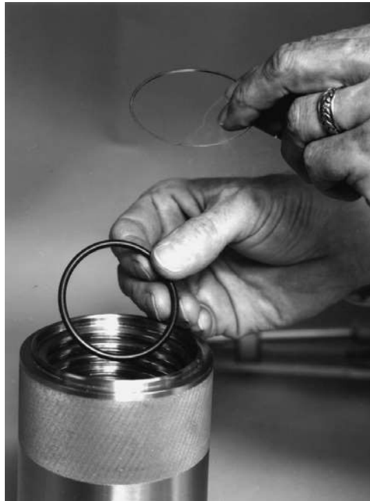
Figura 5-39 Instalando el o-ring y su anillo de soporte
