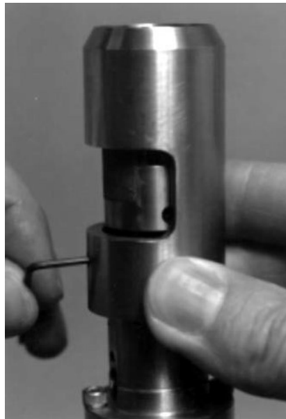
Figura 5-62 Removiendo la tapa del pivote
