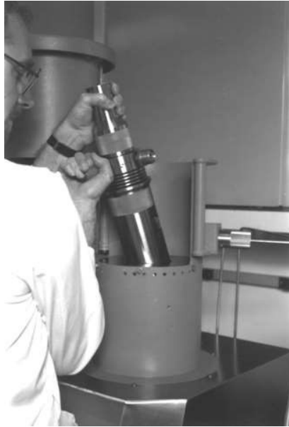
Figura 5-35 Colocando la celda de prueba dentro de la fuente de calentamiento
