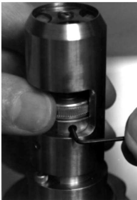
Figura 5-59 Ajustando el manguito del cero
