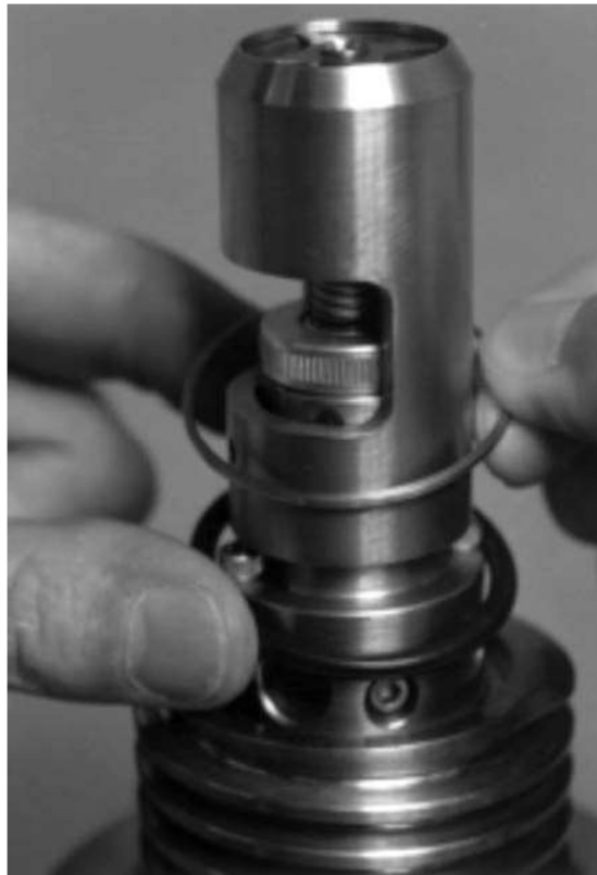
Figura 5-42 Instalando el o-ring y el anillo de soporte de la tapa
