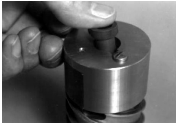
Figura 5-55 Posicionando el buje del rotor
