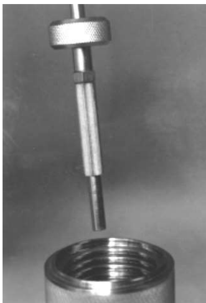
Figura 5-53 Empujando la pista interna hacia el pivote
