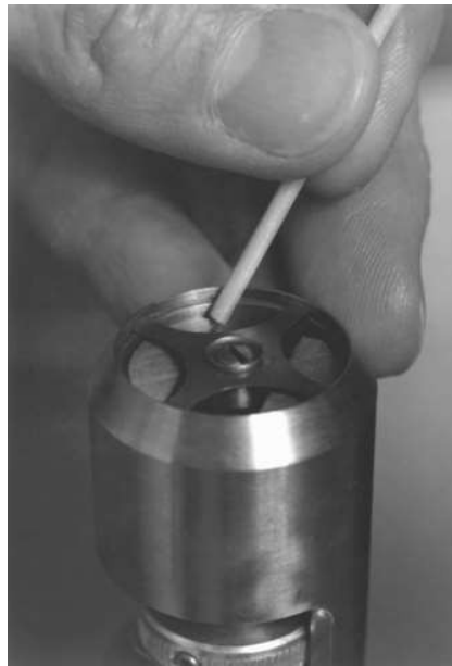
Figura 5-34 Verificando la libre rotación del ensamble de torsión
