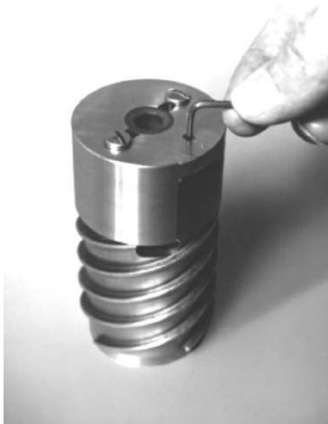
Figura 5-56 Fijando el imán de transmisión
