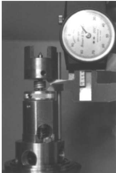
Figura 5-43 Medición del movimiento vertical del imán de torsión
