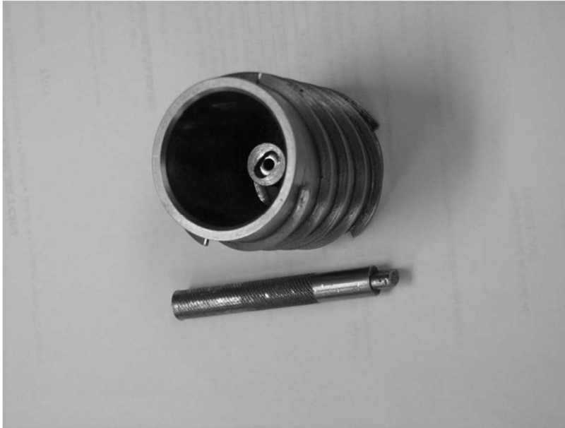
Figura 5-49 Rotor y herramienta para remover bujes
