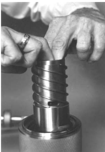
Figura 5-32 Instalando el rotor en la celda
