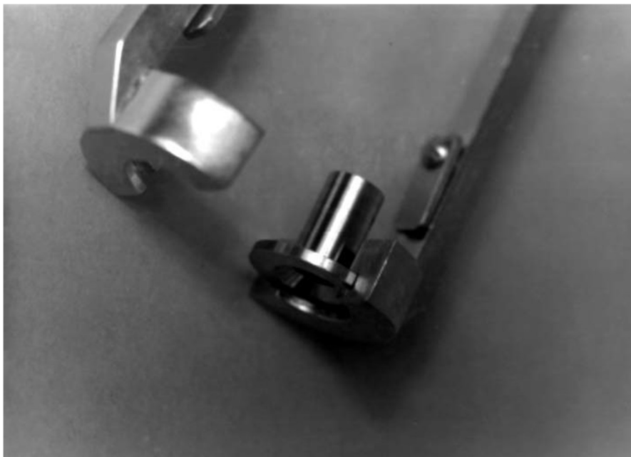
Figura 5-57 El buje del pivote en la muesca del extractor
