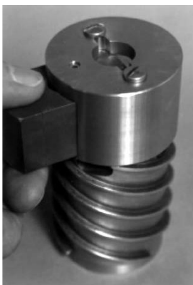
Figura 5-54 Posicionando el imán de transmisión
