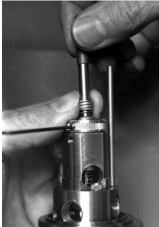
Figura 5-63 Ajustando la longitud del resorte de torsión
