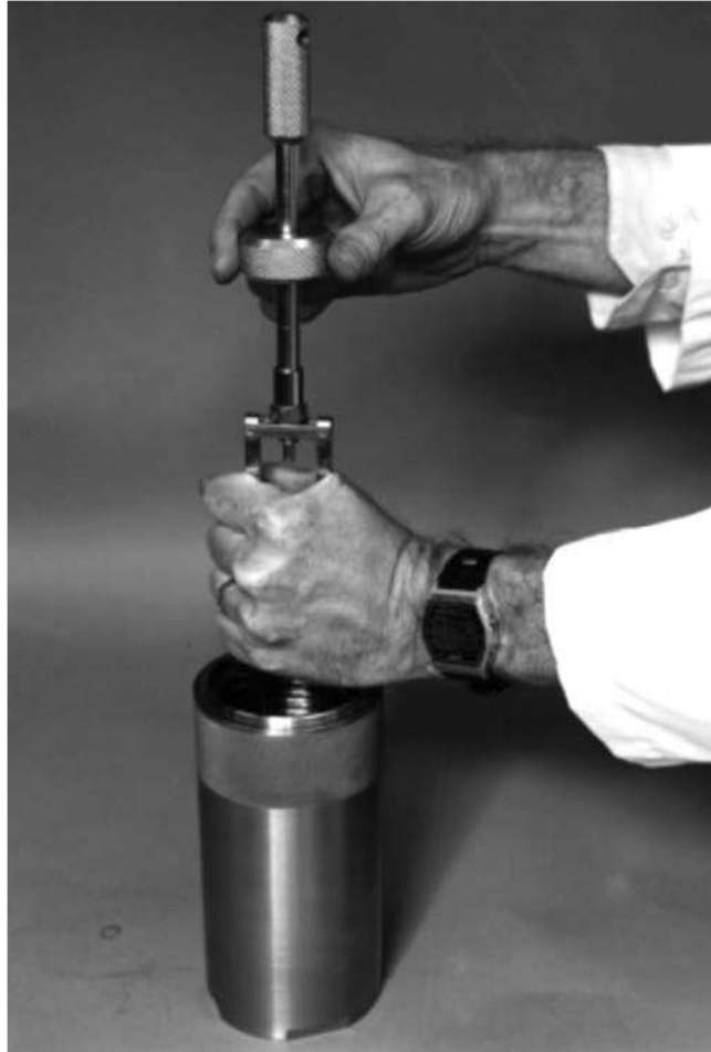
Figura 5-51 Quitando la pista interna del rodamiento o el buje del pivote
