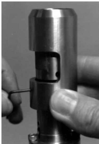
Figura 5-60 Removiendo la tapa del pivote
