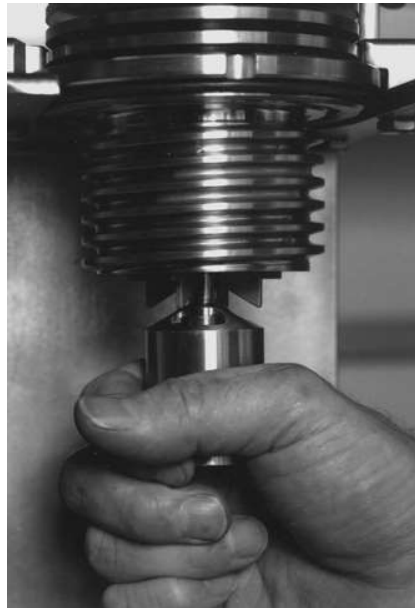
Figura 5-31 Instalando el ensamble del bob
