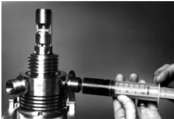
Figura 5-41 Inyectando la muestra
